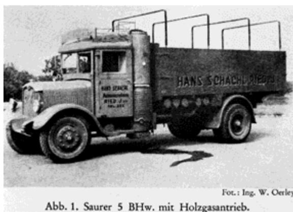
**Рис. 11.** Ещё один немецкий газогенераторный грузовик марки Заурер времён войны (модель 5BHw).
